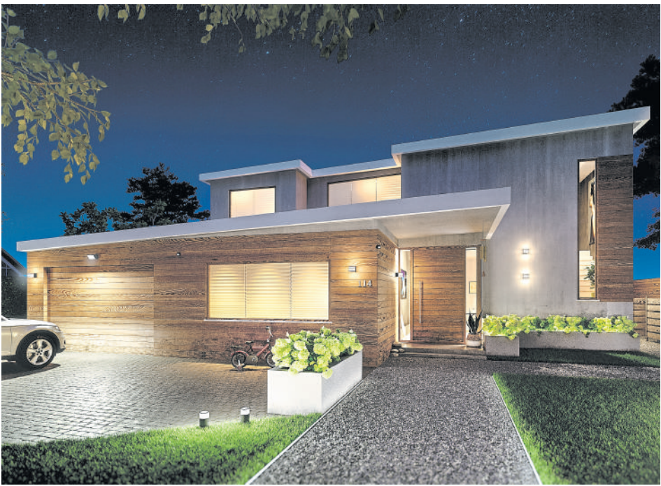
Wandleuchten am Eingang werden im Idealfall in etwa drei Viertel der Türhöhe angebracht. Foto: licht.de/Signify
